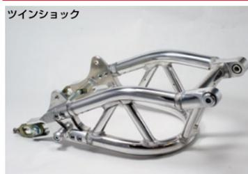
ピボット部分はボールベアリングを標準装備。ピボット部のカ
