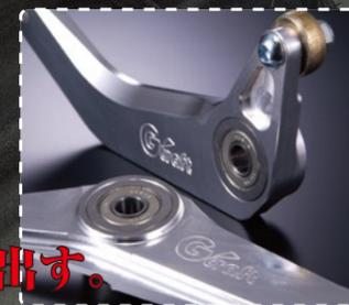
ダブルベアリングが、最高の操作性を生み出す。
