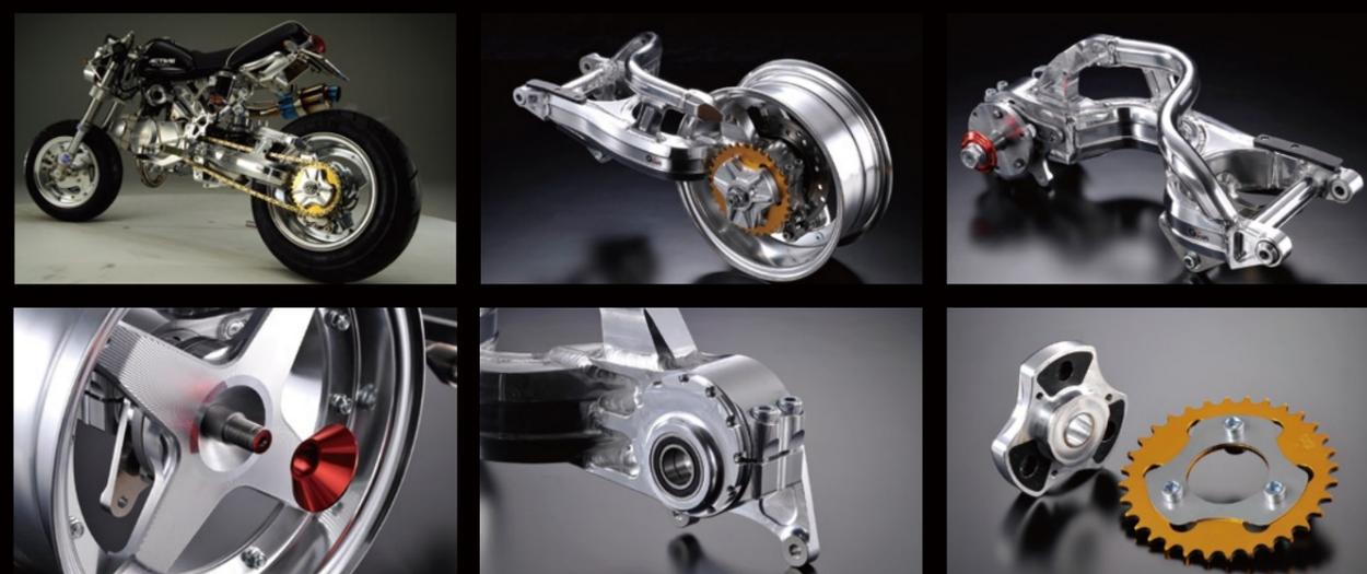
ハブタンバーは標準装備。ビッグバイクと同じ機構を採用することで、ミッションなどの負担を大幅に軽減します。
