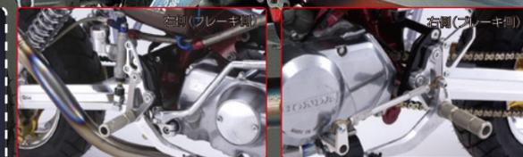
ペダル軸受け部に高精度ベアリングを2個使用。
