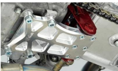
**[39407] 横型エンジン用エンジンマウント補強プレート**
